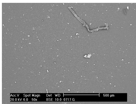
Figura 5 Microfotografía SEM. Superficie de un disco SDI tras filtrar 100 ml de agua pretratada (salida filtros de seguridad).
