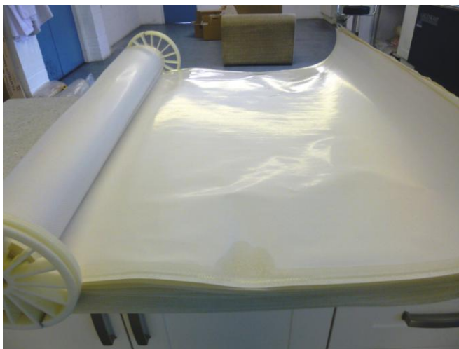
Fig 17: Filmtec BW30-LE Membrane autopsy
